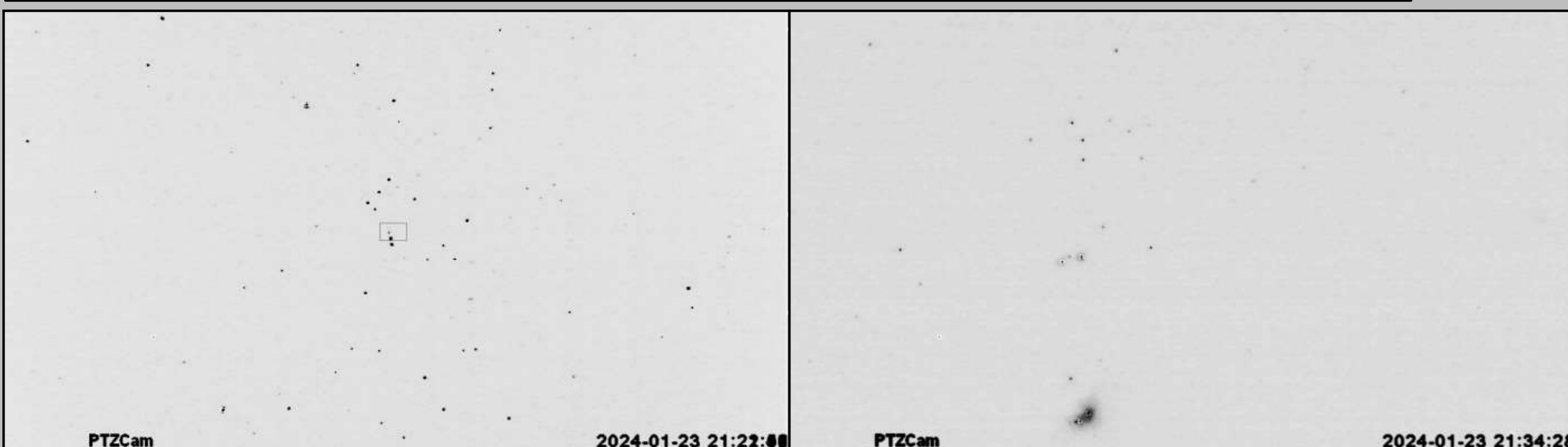
Рис. 3. Слева: серия из 12 снимков участка неба в направлении созвездия Ориона с полем зрения 87 градусов, суммарное время экспозиции равно 12·80 мс, ч/б режим. Справа: снимок участка неба размером 5 градусов, сделанный в том же направлении, что и верхний рисунок (выделен там прямоугольником), время экспозиции — 80 мс, ч/б режим.
